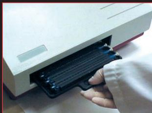
Fig. 9 | Charger la cassette dans le Luminomètre
